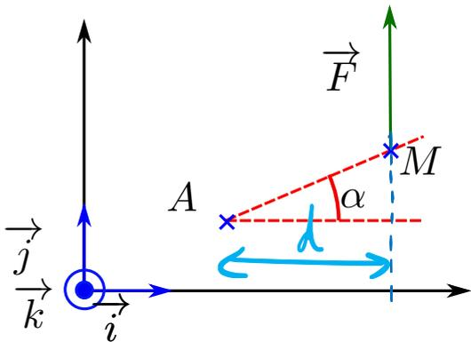
Exprimer le produit vectoriel  $\vec{AM} \wedge \vec{F}$  en utilisant le bras de levier. Vérifier le résultat en exprimant  $\vec{AM}$  dans la base  $(\vec{i}, \vec{j}, \vec{k})$  puis en calculant le produit vectoriel.
