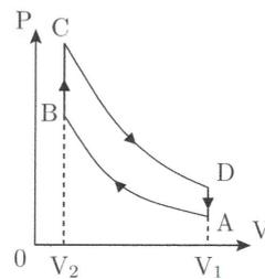
On note  $a = \frac{V_1}{V_2}$  le rapport volumétrique de compression. On donne  $a = 10$  et  $\gamma = 1,4$ .
