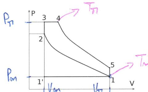
Au point 1 du cycle, la pression  $P_m = 1,0$  bar et la température  $T_m = 293$  K sont minimales. La pression maximale aux points 3 et 4 est  $P_M = 60$  bar et la température maximale au point 4 vaut  $T_M = 2073$  K. Le rapport volumétrique de compression vaut  $\beta = V_M/V_m = 17$ .
