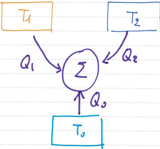
$Q_0$  = énergie dépensée fournie par fluide dans le bouilleur -
